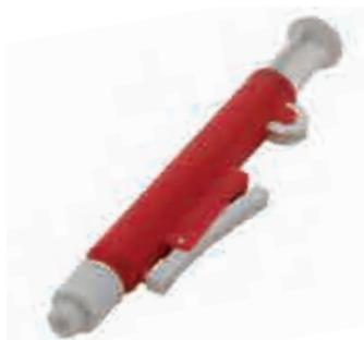
**Aspirador pipetas de 3 válvulas (pera de succión)**
