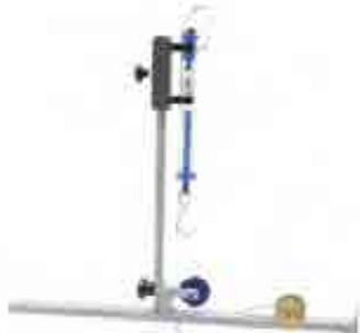
Se compone de un carril en el cual puede deslizarse un cochecito de baja fricción. Al hacer girar el aparato, a través de la máquina de rotación, es posible leer en el eje de rotación del dinamómetro, el valor de la fuerza centrífuga. Además, conociendo el radio, se puede comprobar la fórmula de la fuerza centrífuga.
