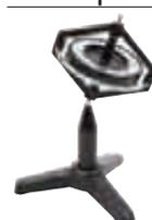
Rueda giroscópica en metal. Poniéndola en rápida rotación a través de una cuerda, se puede verificar la conservación del momento angular. Si se aplica una fuerza perpendicular al eje de rotación, es posible observar el fenómeno de la precesión o bien el efecto giroscópico.
